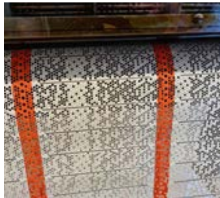
Lochkartenprogramm für Stickereimaschine
