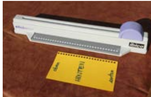
4 Lochung kontrollieren: Sitzen alle Löcher mit gleichem Abstand zum Rand? Falls nein: Karte neu lochen!
