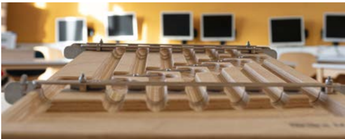
Das Binärsystem zum Begreifen: Die Binäre Murmeladdiermaschine im Informatik-Raum
